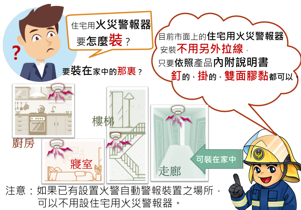
圖 3 住宅用火災警報器裝設示意圖
